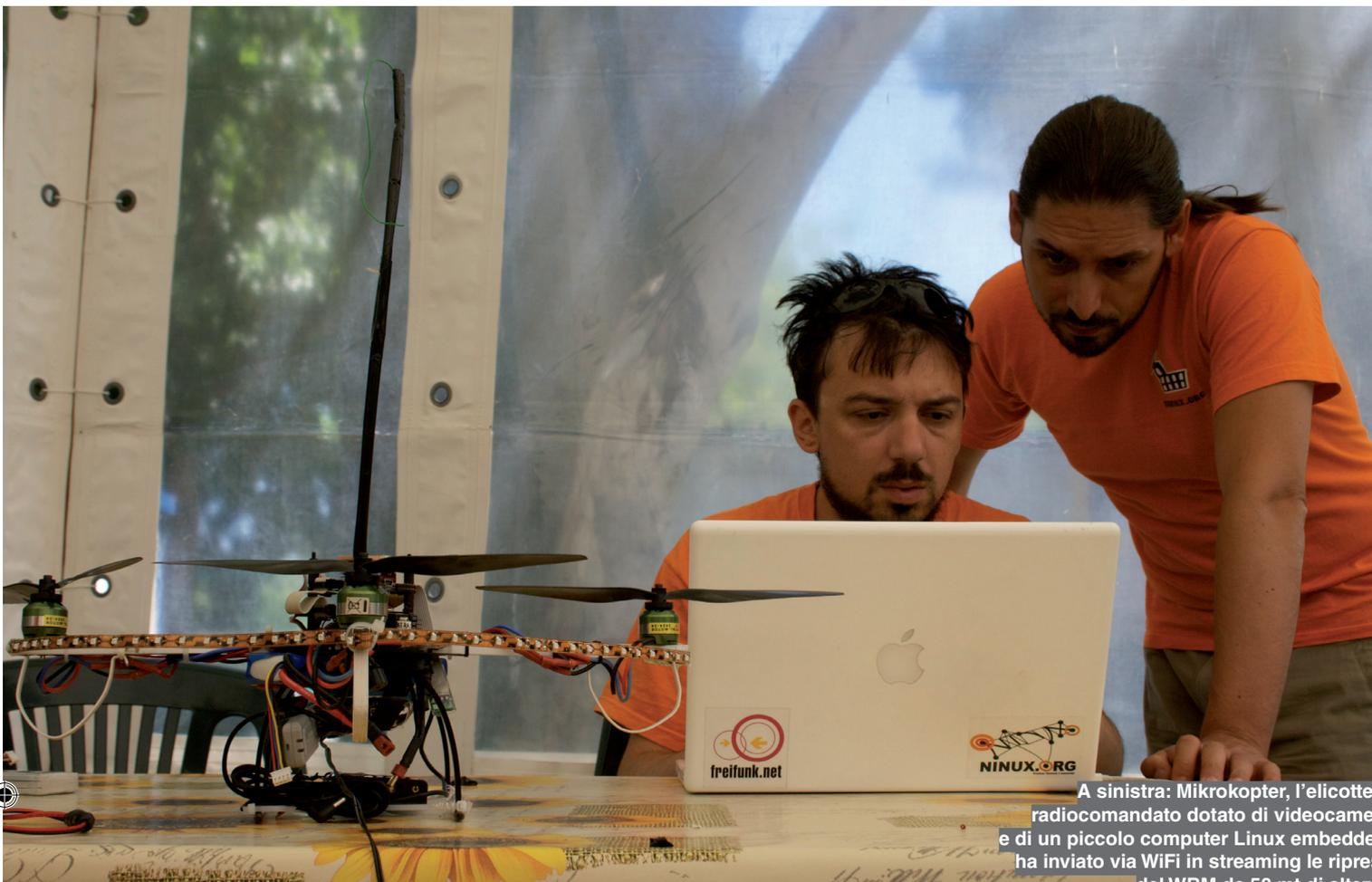
A sinistra: Mikrokopter, l'elicottero radiocomandato dotato di videocamera e di un piccolo computer Linux embedded, ha inviato via WiFi in streaming le riprese del WBM da 50 mt di altezza
